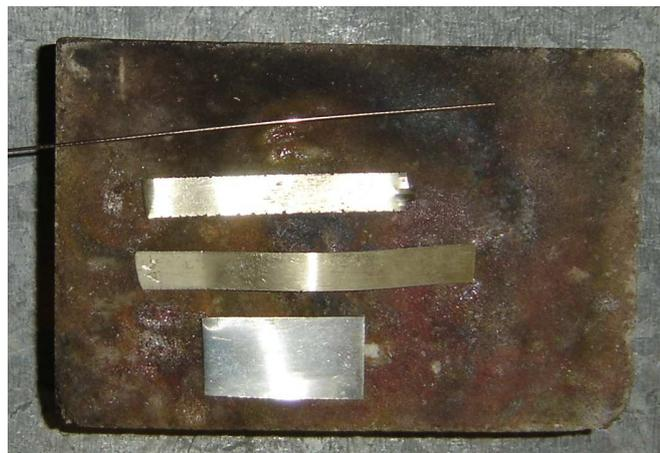
Figura 3: leghe saldanti d'argento ridotte in lastra
